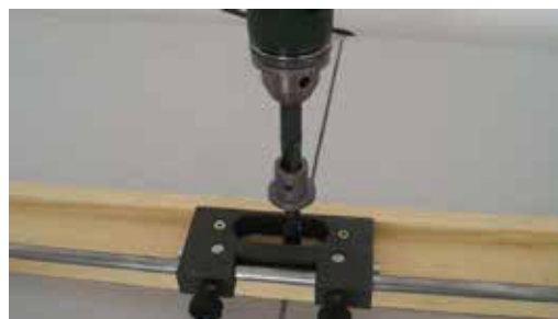
Rys.7. Wiercenie otworów wstępnych wiertłem d.12,5.
