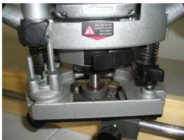
Rys.8. Frezowanie otworów 23x60x30 stosując trzy przejścia.
