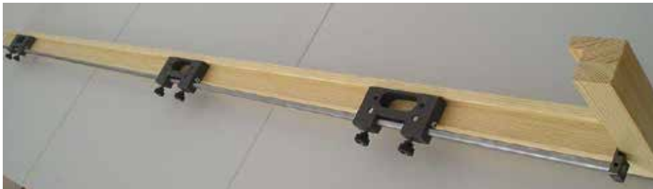
Rys.4. Przewodnica z korpusami umieszczona na ościeźnicy.
