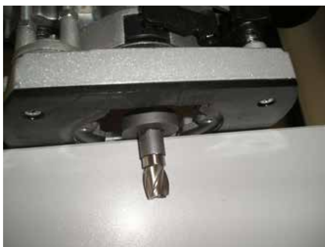
Rys. 9. Odpowiednio wystający frez
