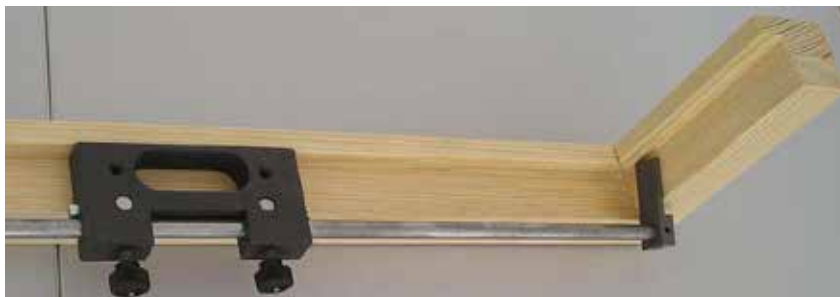
Rys.5. Właściwe ułożenie zderzaka i kołków oporowych
