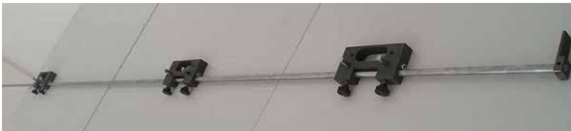
Rys.3. Szablon z korpusami na przewodnicy
