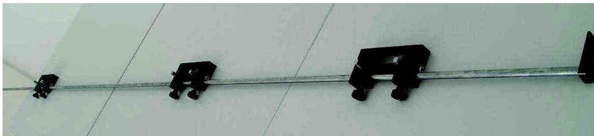
Rys.3. Szablon z korpusami na przewodnicy
