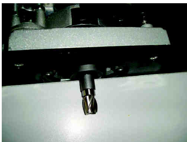
Rys. 9. Odpowiednio wystający frez
