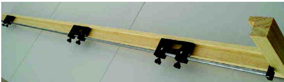
Rys.4. Przewodnica z korpusami umieszczona na ościeźnicy.
