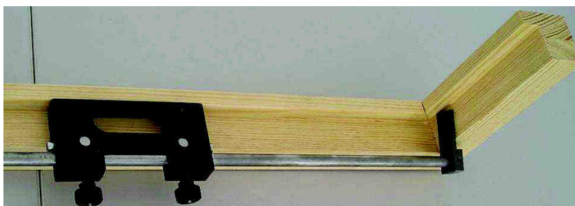
Rys.5. Właściwe ułożenie zderzaka i kołków oporowych
