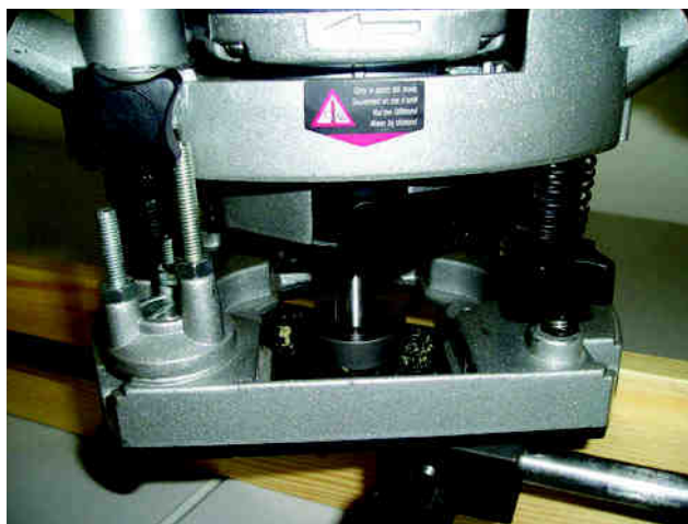
Rys.8. Frezowanie otworów 23x60x30 stosując trzy przejścia.
