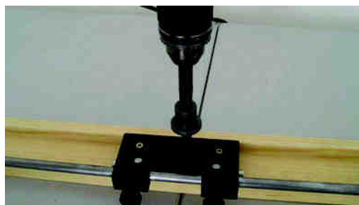
Rys.7. Wiercenie otworów wstępnych wiertłem d.12,5.
